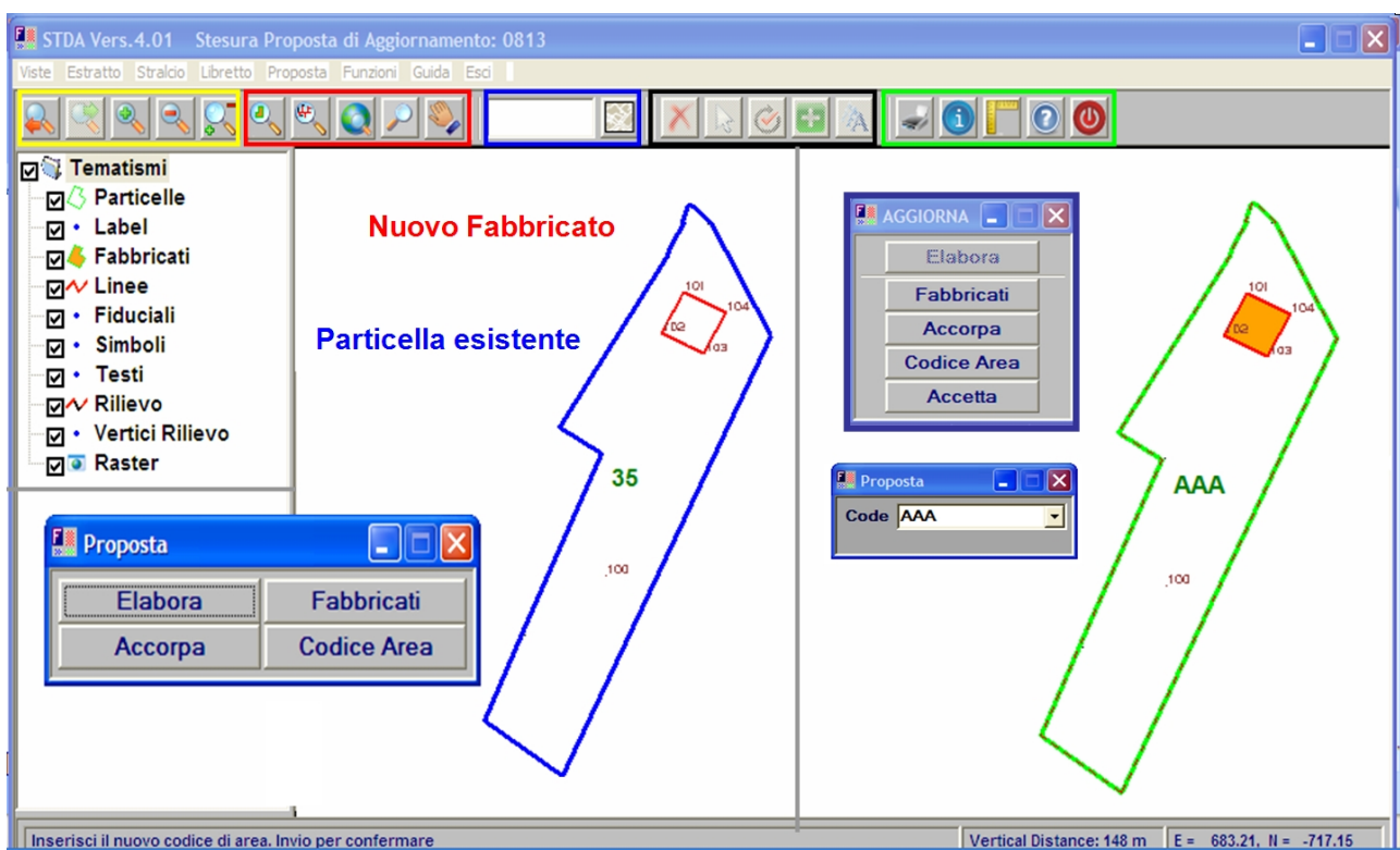
Fig. 1 - Nuova interfaccia grafica implementata nella procedura Pregeo 10 ed esemplificazione della predisposizione della proposta di aggiornamento cartografico.
